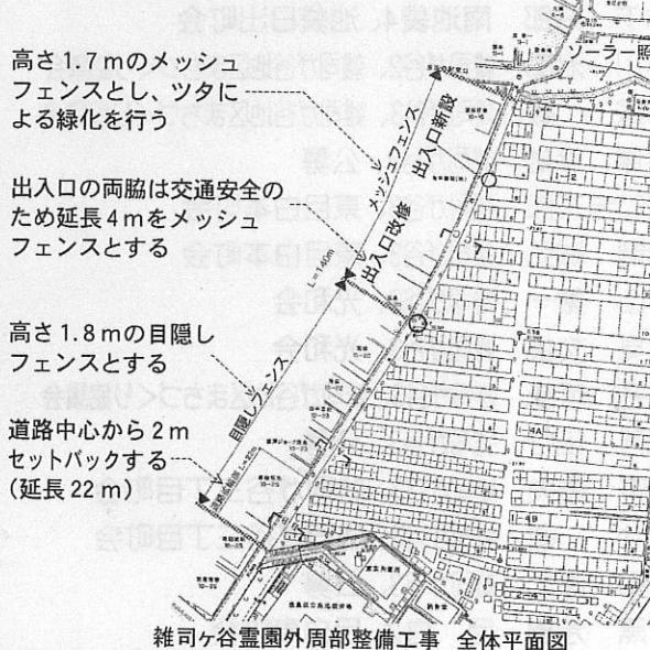
スとし、ツタによる緑化を行います。南側は高さ1.8mの目隠しフェンスとします。
